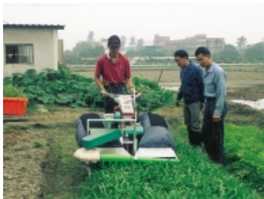
圖8. 小葉菜收割機田間作業情形
