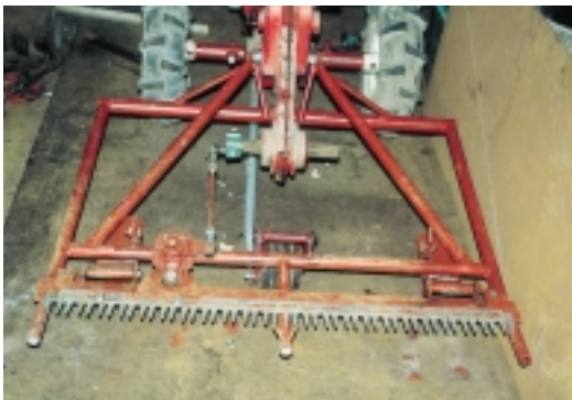
圖6. 刀剪安置與動力傳動情形
