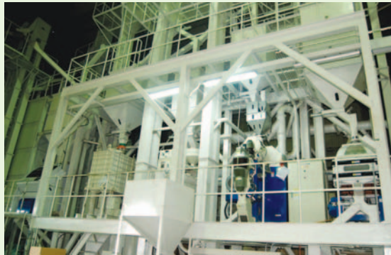
這套台灣唯一的「自動精米設備」，高度將近3層樓，可密閉一貫化作業
