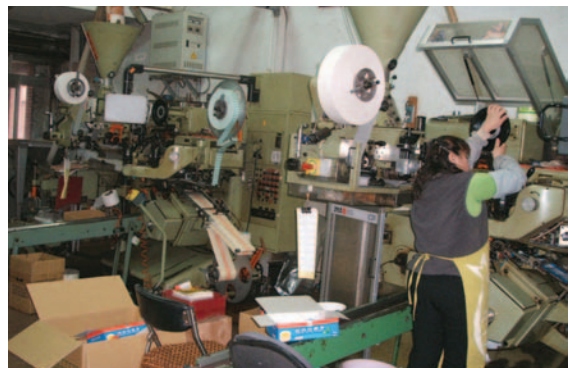
石農茶工廠自義大利、日本進口全自動袋茶包裝機及原片茶包裝機
