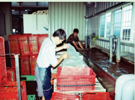
上沖下洗清洗作業
