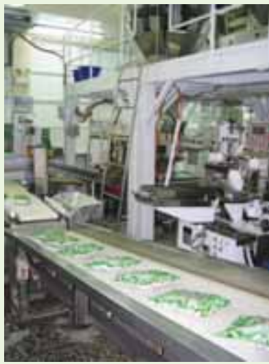
通過金屬探測器的自動化包裝
