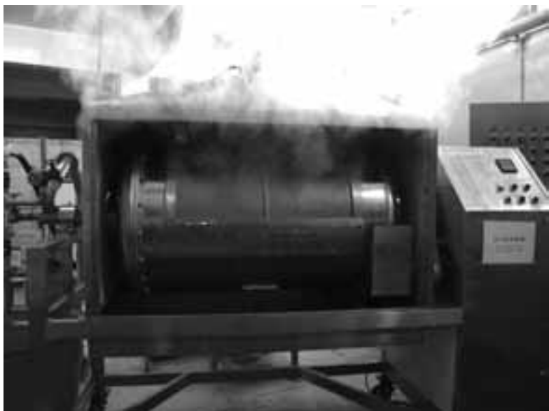
多功能製麴機外觀 (在蒸煮過程中)
