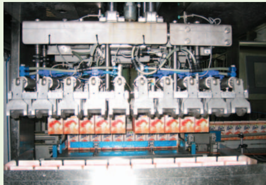
機器手臂正進行裝箱作業
