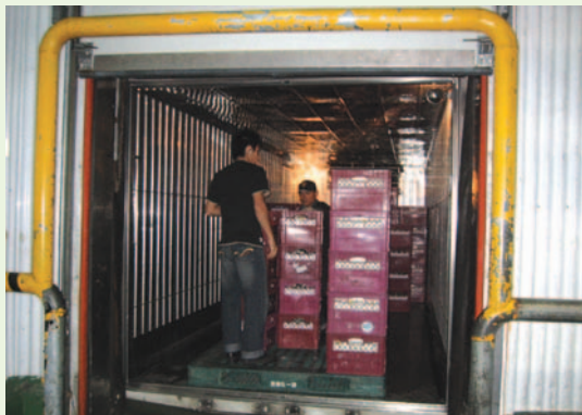
運輸車需先預冷，達到 7°C 以下才可開門，以達到最安全的冷藏產品運輸環境
