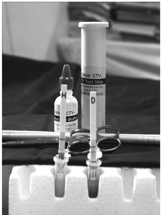
柑桔萎縮病毒膠金抗體檢測試劑組，包含試紙條、萃取緩衝液、研磨棒與小試管等
