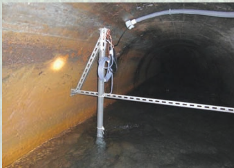
南投農田水利會關刀溪自動測報測站水壓式水位計
