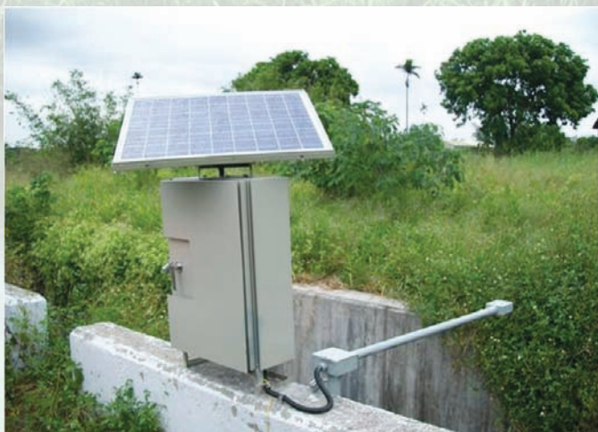
雲林水利會柳子圳幹線自動測報現地系統（超音波水位計及太陽能供電系統）
