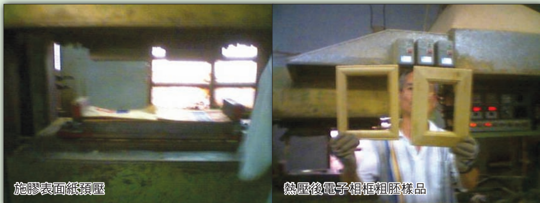
圖 9. 電子相框產品的熱壓粗胚
