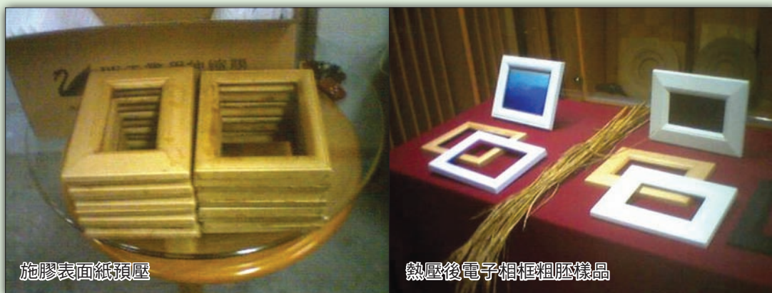
圖 10. 完成表面噴塗的稻草電子相框產品
