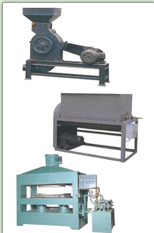
圖 4. 塑合製程設備—（由上而下）破碎機／混膠機／熱壓機
