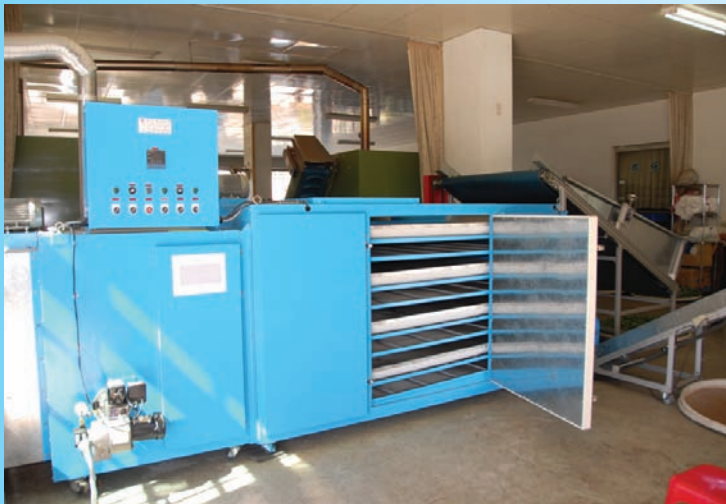
圖 6. 茶菁萎凋槽內 4 層不鏽鋼輸送網帶
