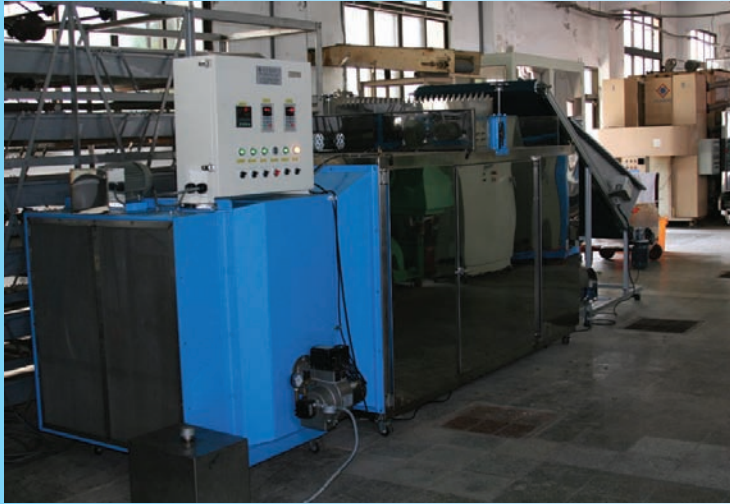
圖 5. 加熱部-藍色部分含控制箱
