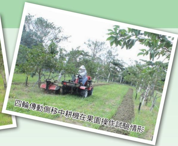
四輪傳動側移中耕機在果園操作試驗情形
