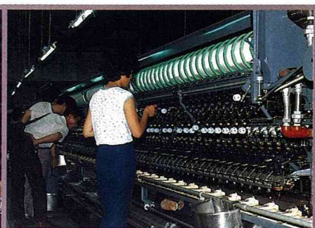
這些蠶繭已可結絲，必須聚集好幾條由不同蠶繭抽出來的絲，以便製成一條厚度夠的絲。
