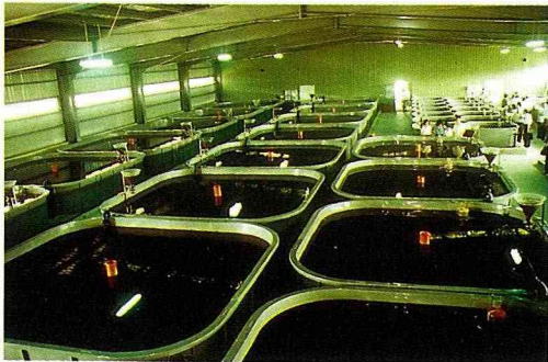
華泰養殖廠工廠化生產的室內超高密度循環水養殖系統，是我國養殖漁業邁入自動化時代的里程碑。(圖／農委會漁業處)
