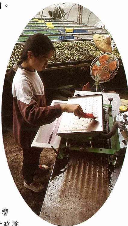
■推廣農業機械化，可降低生產成本，圖為花卉自動播種機。
