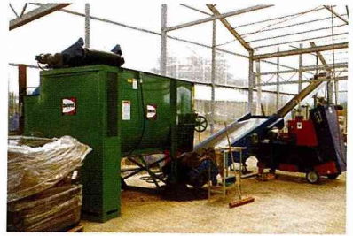
▲培養土進入室內，在攪拌器內混合均勻（左方綠色機器）再由傳送帶送入右方自動裝盆機。
