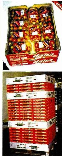
水果平穩的排放在紙箱底層，新紙箱的高度就可以縮短6mm；採用紙墊襯隔，得以多堆積2層水果，因此降低運輸成本。
