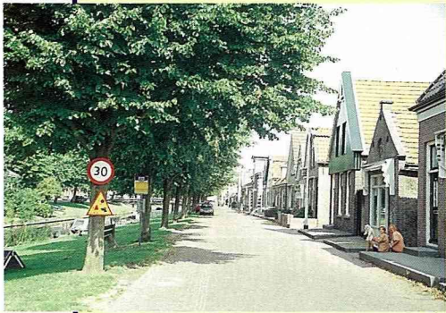
■車道與河道之間有綠帶作為緩衝，亦可防止馬路上的污染物直接流入運河。
