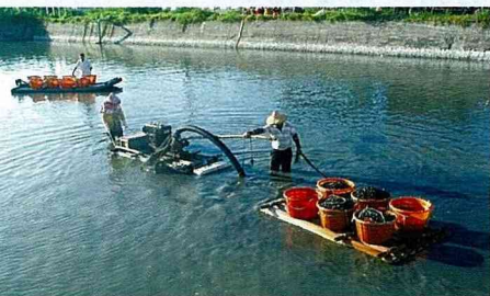
■傳統收穫機(蛤仔機)由一人拖曳後退倒行，另一人拉動網具收穫。
