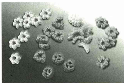
■ 圖一：利用「雙軸擠出」技術製成的食品「膨化粒」。
