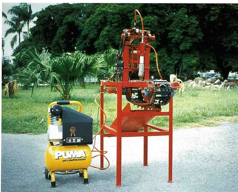
■ 台東區農業改良場研製之半自動洛神葵去子機，作業效率為人工之3倍。
