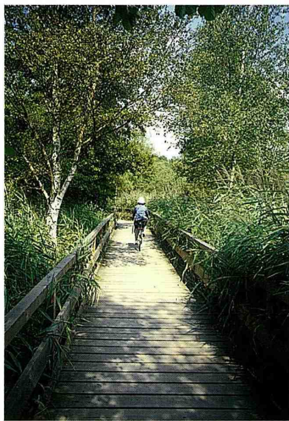
■ 設置高架木橋通過沼澤區，避免遊客破壞沼澤生態。
