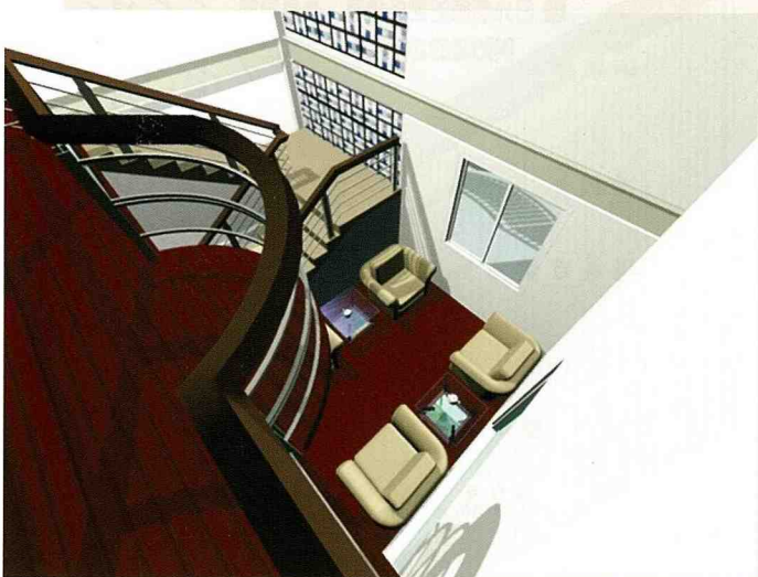
■ 樓梯及休憩空間：藉由煙囪效應原理，熱氣均可藉著氣流循環，經由樓梯間及開放空間，最後由三樓屋頂最高點的氣窗排出，加上各層窗戶間的空氣流動，室內溫度會是涼爽宜人的，另外樓梯間及開放空間外牆上之玻璃磚，可使室內空間更為明亮。
