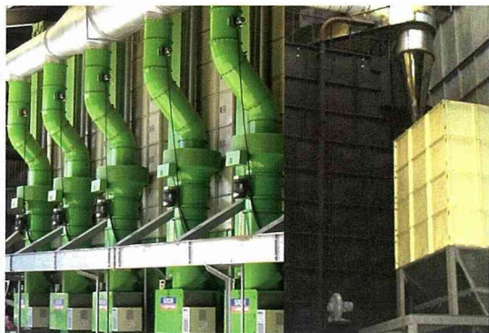
圖左是低溫乾燥機，圖右為稻殼燃燒爐和灰爐貯存桶
