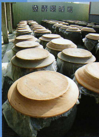
傳統陶缸露天曝曬發酵
