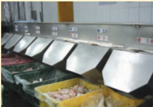
分級機將各式雞塊按大小分裝，圖中為雞腿分級機
