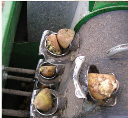
透過輸送帶將種子從凹槽運出，再輸送到土裡
