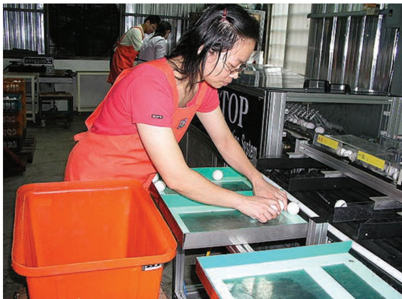
機器分級後，再由人工將蛋依照分級統一放置
