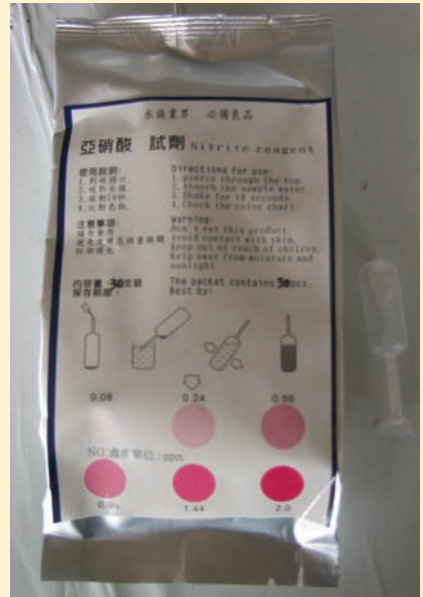
班員每天得利用各種試劑進行水質測試，圖中是亞硝酸試劑
