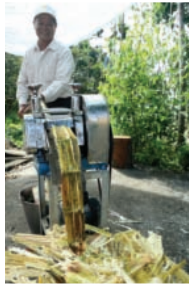
整枝甘蔗在特製的榨枝機中榨出原汁，蔗渣回收當堆肥
