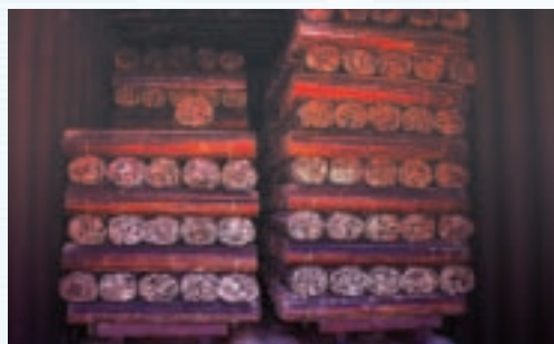
竹炭加工製程前之煙燻處理
