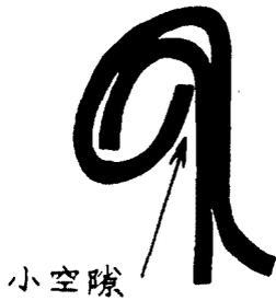
圖三係 (A) 罐身接縫 (lap) 部分，在第一次捲封完畢之正常情形。因罐鉤 (Body Hook) 內有兩層鐵皮故較厚，所以當蓋緣恰能與罐身相接觸時，則在接縫 (lap) 以外罐身之其他部分，因非兩層鐵皮，故蓋緣與罐身間一定有個可容指甲 (fingernail) 插入的小空隙。如第三圖 (B)
