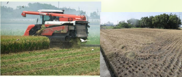
圖一、SOP 步驟 1：利用水稻收穫機將稻草斬斷成 5 至 7 公分。
