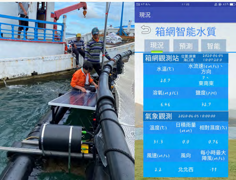
◎智慧箱網監測系統設備與 APP 介面
