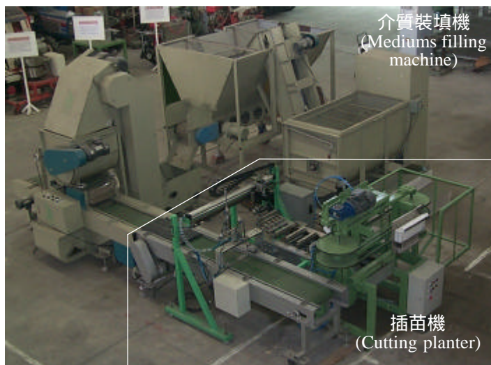
圖二、已連結一貫化介質裝填機械之菊花穴盤苗自動插苗機。 (插苗機為圖中右下之前半部，後半部則為一貫化介質裝填機)
