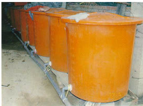
▲社區家庭垃圾集中處理場之大型堆積桶
