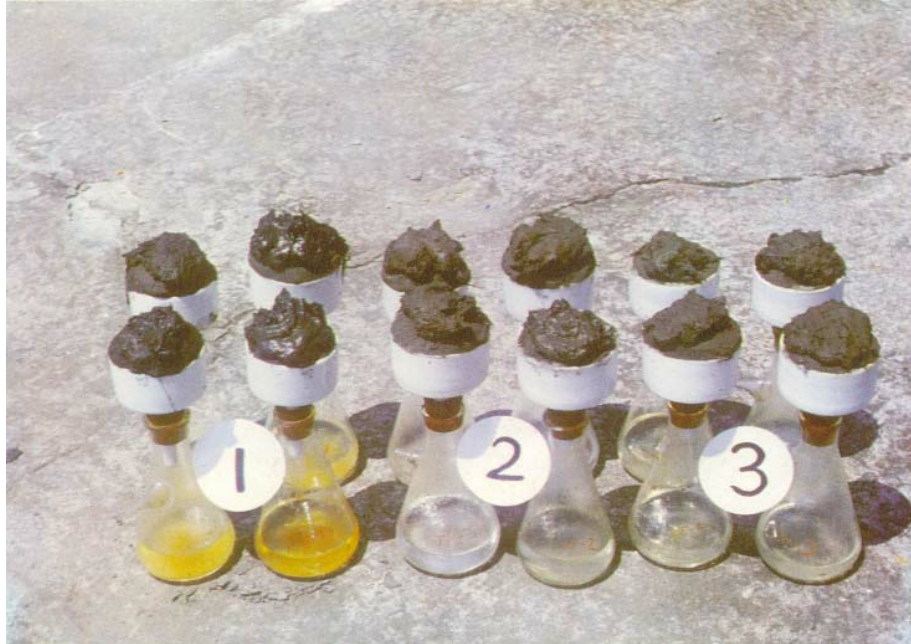
圖 2 未排水之對照區新鮮土壤之飽和抽出液呈現含有鐵化物之黃褐色，埋設塑膠浪管區及埋設塑膠浪管又施穀殼區之排水良好，新鮮土壤之飽和抽出液是透明無色。
