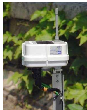
圖五、NASA 噴射引擎實驗室 Sensor Web 模組。
