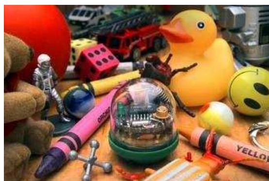
圖五、NASA 噴射引擎實驗室 Sensor Web 模組。
