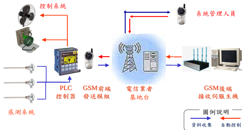
圖十四、臺中區農業改良場所開發溫室遠距無線傳輸監控系統架構圖。
