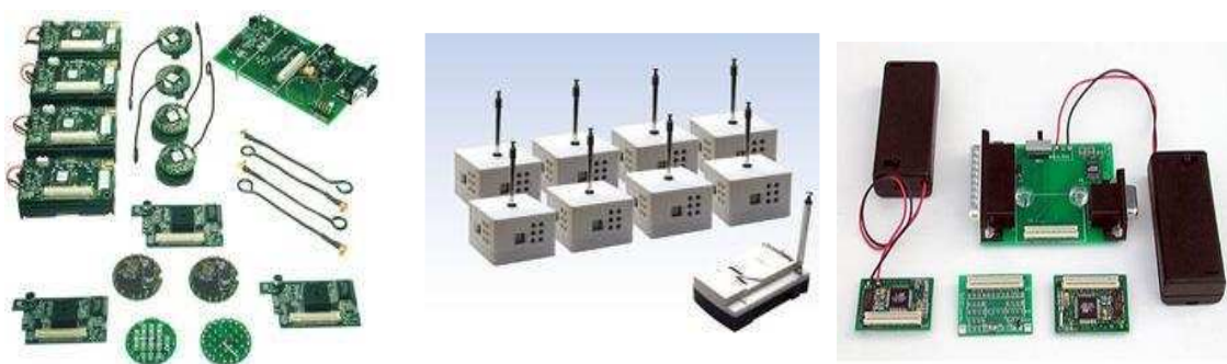
圖二、CrossBow 公司所出品 Mote 系列模組與系統開發套件。
