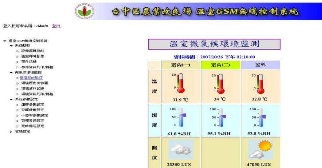
圖五、GSM 遠距無線監控系統控制網頁。
