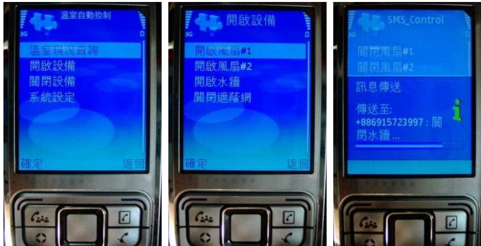
圖四、GSM 遠距無線監控系統行動電話控制介面。
