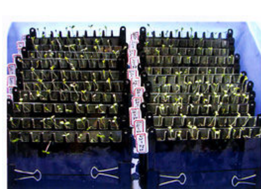
▲ 2. 係不同品種萵苣使用種苗抗病性與抗逆境力之檢測裝置播種後四天之生長情形（圖左）且由玻璃面可調查根長與計算萌發率（圖右）。
