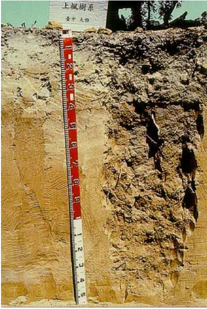
圖一.合理化施肥必須考慮土壤剖面特性砂頁岩沖積土。
