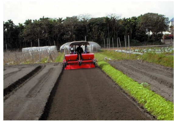
▲ 圖五、舉升作畦器後，可單獨進行整地之功能，亦可配合肥料之施用
