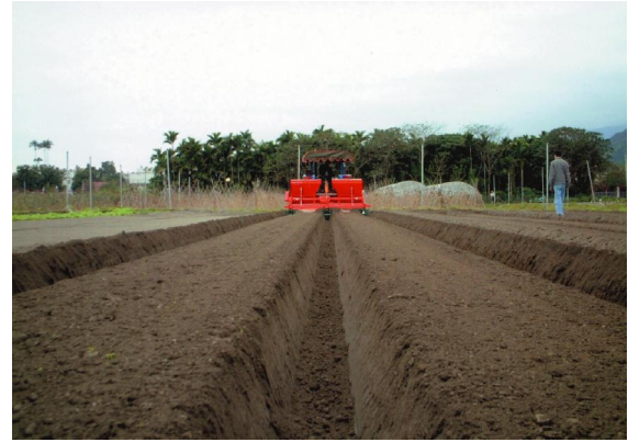
▲ 圖三、利用本機製作畦床，畦面寬可調範圍40-80公分，畦溝深28公分，畦溝上寬30公分
