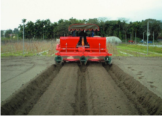
▲ 圖二、利用三組開溝器完成一次二全畦田間作業情形
