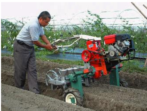
圖四、承載型蔬菜種子直播機在畦上播種作業情形
