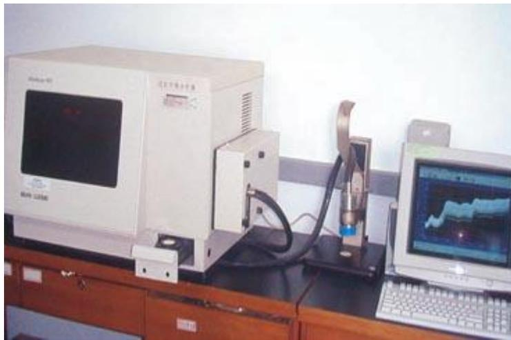
要利用近紅外光來分析某種成份前，必須先建立此成份之分析檢量線來作為分析之基礎。其程序為先收集此成份含量高低不同之許多樣品，將所有樣品以近紅外光分析儀掃描取得光譜，以了解在各個波長下樣品之吸光現象，再以傳統化學分析方法取得該成份之化學值，將樣品之光譜與化學值對照，以統計方法建立分析檢量線，即可利用此檢量線方程式
