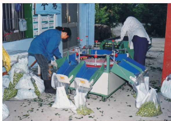
圖6. 圓盤式分級機分級作業的情形
