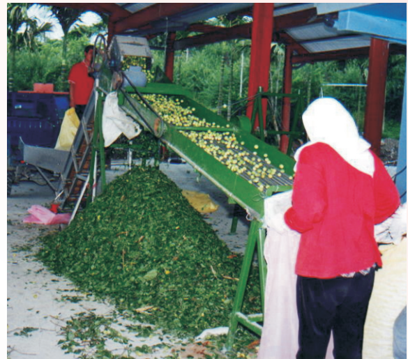
圖4. 大型青梅去雜機篩除雜枝葉作業
