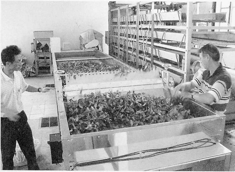
圖四、多功能茶菁水份去除機作業情形
