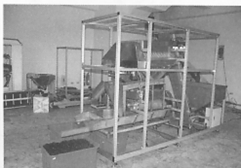
▲條形包種茶精選機正進行精選作業中
