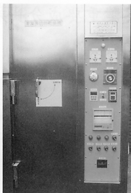
◀圖 3：茶葉多功能乾燥機通氣調節閥及控制面板
