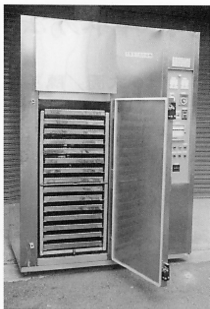
◀圖 2：茶葉多功能乾燥機內部盛茶盤架
