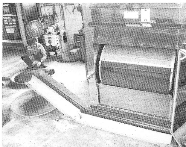
圖2、臥式滾筒茶葉烘焙機出料作業
