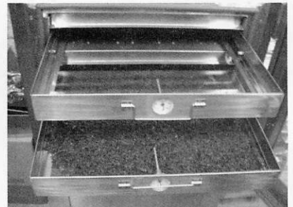
圖2.遠紅外線真空焙茶機內部及透明強化玻璃之茶葉托盤
